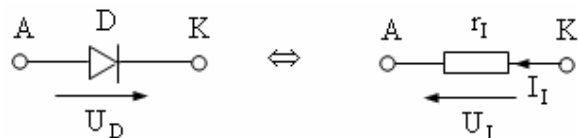
Fig.5.28 Schema echivalentă simplificată a unei diode blocate
