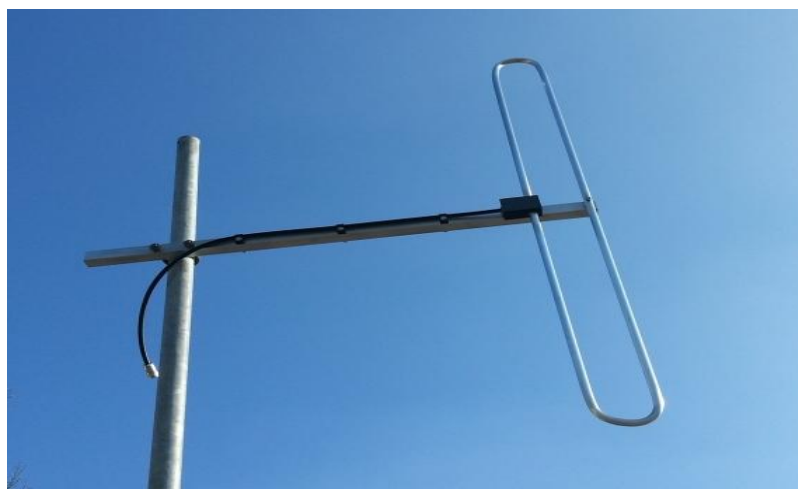
Figura 3.93 Antena Dipol Împăturit [17]
