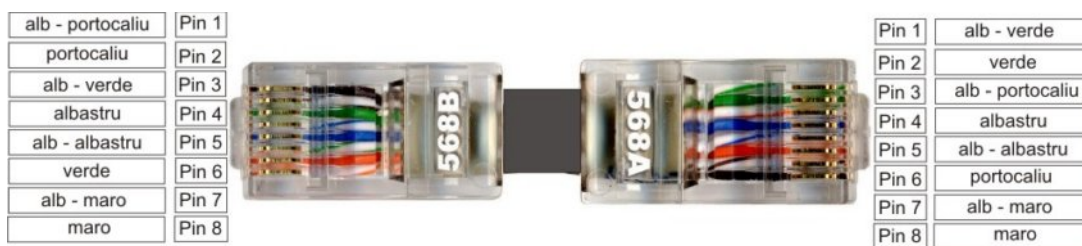
Fig. 9.10. Ordinea firelor într-un cablu Cross-Over (cablu inversor)
