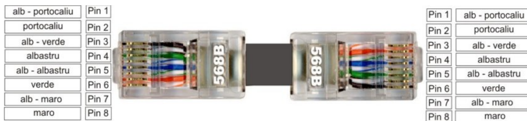
Fig. 9.8. Ordinea firelor într-un cablu Straight-Through (cablu direct)
